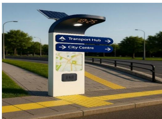
تصویر ۱۸- طراحی پیشنهادی تابلو شهری با امکان استفاده توسط نابینایان، کاربران ویلچر و افراد سالمند، همراه با نقشه برجسته و دکمه صوتی.
