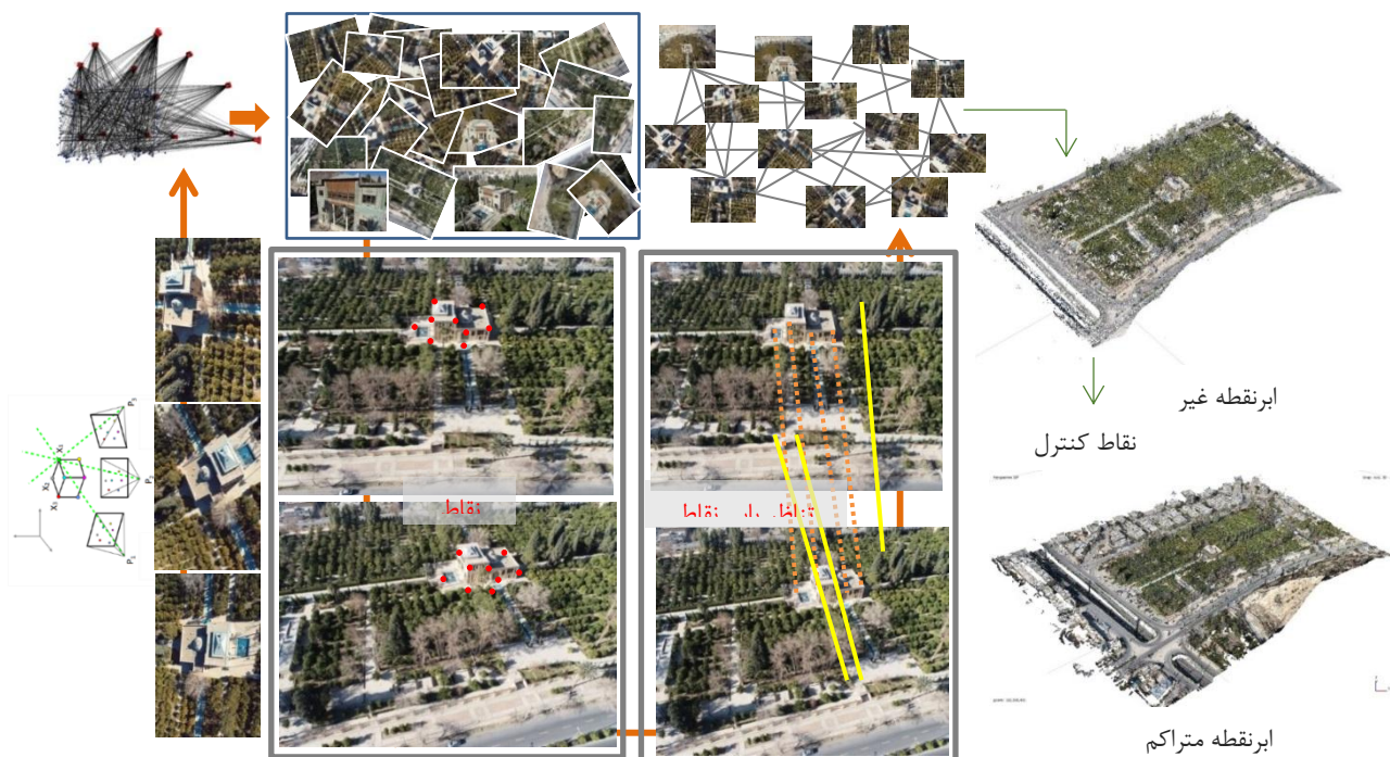
شکل ۵: شناسایی و تطبیق نقاط کلیدی جهت تولید ابرنقاط از تصاویر پهپاد، مأخذ: نگارندگان
