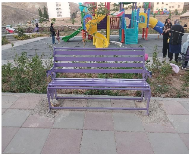
تصاویر ۵-۶- نیمکت شهری فاقد فضای جانبی برای استقرار ویلچر و بدون ویژگی‌های ارگونومیک مناسب برای سالمندان و کاربران دارای ناتوانی حرکتی.
