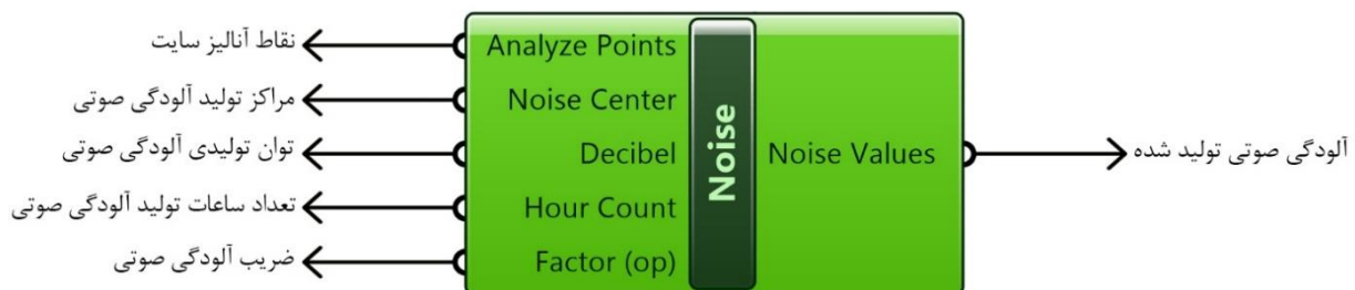
شکل ۶. الگوریتم بررسی آلودگی صوتی تاثیرگذار در بستر سایت بر اساس متغیرهای وابسته و مستقل ورودی
